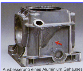
Ausbesserung eines Aluminium Gehäuses
