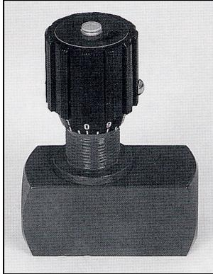
Die Strömventile der Baureihe NDRV dienen zum Absperren oder Regeln flüssiger Medienströme. Die Drosselfunktion wirkt dabei nur in einer Richtung. In der Gegenrichtung wirkt das integrierte Rückschlagventil mit einem Öffnungsdruck von 0,5 oder 4,5 bar. Die Durchflussmenge wird durch Drehen des Zylindergriffs von Null bis zur vollständigen Öffnung ablesbar reguliert und durch Klemmschrauben gesichert.
