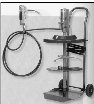
Druckluftschmiergerät, fahrbar, 3,5 m Hochdruckabschmier-Schlauch DN 6, Anschlussgewinde R 1/4", Druckluftaggregat, Hochdruckabschmierpistole mit Lineardrehgelenk und Düsenrohr mit 4-Backen-Hydraulikgreifmundstück, Fettfolgekolben und Staubschutzdeckel, stabiler Fahrwagen.
