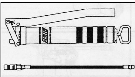
Business-Ausführung, Kurzhubsystem, stufenl. Kolbenstangenfixierung durch Permanent-Spring-Load, mit Hochdruck-Kunststoffschlauch (mehrlagig, Berstdruck 1000bar, 300mm, Dm 9mm), 4-Backen-Hydraulikgreifmundstück (gedrehte, gehärtete Backen), eingeschweisst im PE-Beutel, TÜV, DLG, BLT geprüft, für 400g Kartuschen oder 500g loses Fett.
