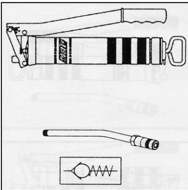
Mit Spezial-Entlüftungsventil, öldichtem Innenkolben, Füllvolumen 500 ccm, Kurzhubfördersystem, im Karton verpackt. Zubehör-Sets mit Hydraulik-Greifmundstück mit Rückschlagventil auf Anfrage.
