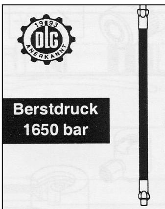
Hochdrucksicherheitsschlauch Dm 13 mm, Berstdruck 1650 bar (Stahlgeflechteinlage), Anschlussfittings mit Sechskant für beschädigungsfreie Montage.
