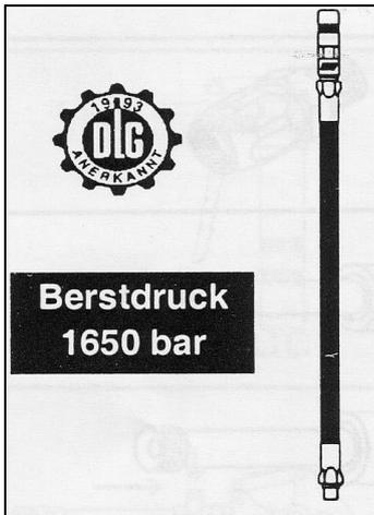
Hochdrucksicherheitsschlauch Dm 13 mm, Berstdruck 1650 bar, Anschlussfittings mit Sechskant für beschädigungsfreie Montage, kpl. Mit 4-Backen-Hydraulikgreif-Mundstück (gedrehte, gehärtete Backen).
