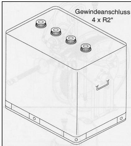
Vorrats- und Entsorgungstank doppelwandig zugelassen für Flüssigkeiten der Gefahrklasse A3, nahtlos geblasene HDPE-Innenbehälter, vollverzinkter Stahlblech-Außenbehälter, korrosionsfest und wartungsfrei, keine zusätzliche Auffangwanne oder Auffangraum notwendig. TÜV-überwachte und DIN/ISO-zertifizierte Qualitätsfertigung. Vormontierte Füllstandsanzeige.
