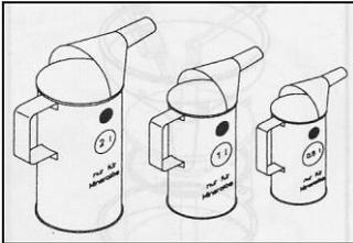
Hochwertiges Weißblech, trichterförmiger Aufsatz, Eichplomben gem. Eichvorschrift mit Prägung „nur für Mineralöle“.
