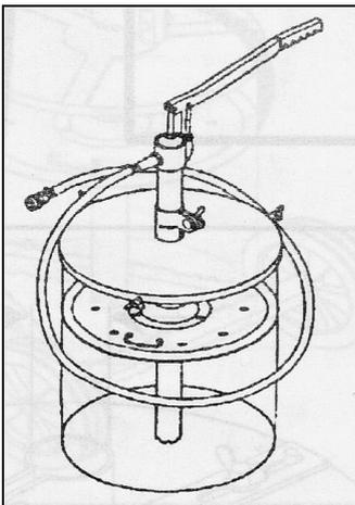
Füllgerät mit Schraubdeckel, mit 3 seitlichen Stellschrauben und Folgekolben, ZSA-Kupplung nach ISO-Norm 7241B DN6/R14.
