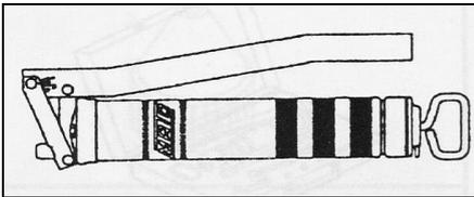
Business-Ausführung, Kurzhubsystem, stufenl. Kolbenstangenfixierung durch Permanent-Spring-Load, verpackt im PE-Beutel, TÜV, DLG, BLT geprüft, ohne Zubehör, für 400g Kartuschen oder 500g loses Fett.
