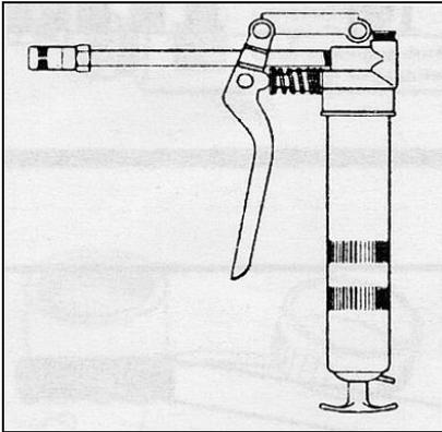
Solide Einhandpresse für Fette bis Konsistenz 2 mit geradem Düsenrohr und 4-Backen-Hydraulikgreifmundstück. Füllvolumen 130 ccm, Druckleistung 200 bar, füllen durch Füll-Gerät oder durch einsaugen aus dem Fetteimer.
