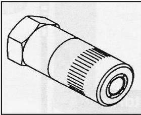
Hochwertiges Qualitätsmundstück DIN 1283 für H-Nippel DIN 71412 mit gedrehten und gehärteten Greifbacken für optimale Dichtwirkung, Sechskant SW15.
