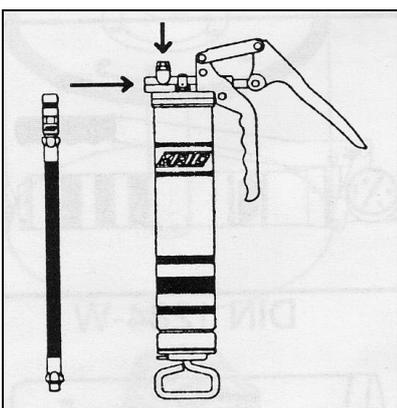
Für 400g-Kartuschen u. loses Fett, mit Füll- und Entlüftungsrippel (mit Füllgerät befüllbar), Druckleistung bis 300 bar, Sicherheits-Gummipanzerschlauch (Stahlgeflechteinlage, Berstdruck 1650bar) Mit 4-Backen-Hydraulikgreifmundstück, verzinkt, im Karton.
