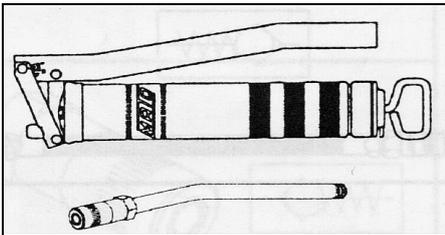
Business-Ausführung, Kurzhubsystem, stufenl. Kolbenstangenfixierung durch Permanent-Spring-Load, mit verzinktem Stahldüsenrohr, 4-Backen-Hydraulikgreifmundstück (gedrehte, gehärtete Backen), eingeschweisst im PE-Beutel, TÜV, DLG, BLT geprüft, für 400g Kartuschen oder 500g loses Fett.
