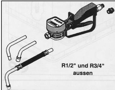
Handdurchlaufzähler mit LCD-Anzeige, Drehgelenk, mit Auslauf und Pistole, Messbereich bis 40 l/min, 2 Zählbereiche (total und rückstellbar), Messgenauigkeit +/-0,5%, kalibrierbar, mit Anschluss-Doppelnippel R 1/2" und R 3/4" außen.
