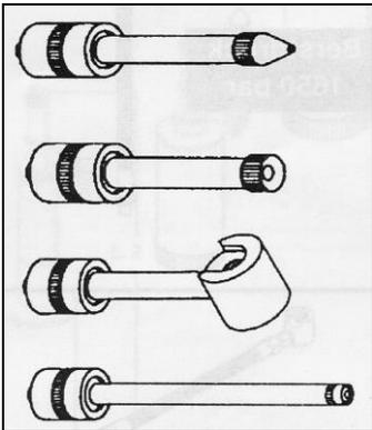
Düsenrohr mit Schnellwechselkupplung F12 m. Spitz-Mundstück
