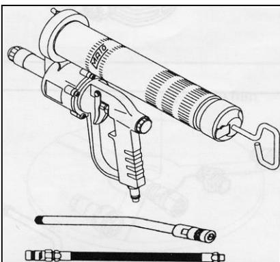
Füllung durch Fettkartuschen 400 g, Füllgerät oder loses Fett, Anschlussgewinde R 1/8", für Fette bis NLGI-Klasse 2 DIN 51818, Einzelanschlussystem, Förderleistung 1 ccm/Hub, Druckübersetzung 1:60, Luftdruck min. 3 bis max. 8 bar, max. Betriebsdruck 480 bar.
