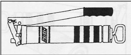
First-Class-Ausführung, Kurzhubsystem, stufenl. Kolbenstangenfixierung Permanent-Spring-Load, Füll-/Entlüftungs-Ventil, ergonom. Handgriff, Display-Karton, TÜV, DLG, BLT, ohne Zubehör, für 400g Kartuschen oder 500g loses Fett.
